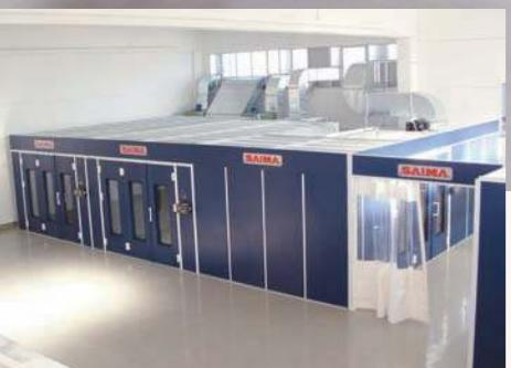
L'esperienza trentennale di SAIMA ha permesso la creazione di Beta, cabina progettata per soddisfare le esigenze del carrozziere con l'obiettivo di durare nel tempo. Il frontale, a tre ante ad apertura totale con porta di servizio laterale, è inserito in una struttura interamente composta da pannelli in lamiera plastificata a doppio foglio, con interposto coibente termoacustico.
