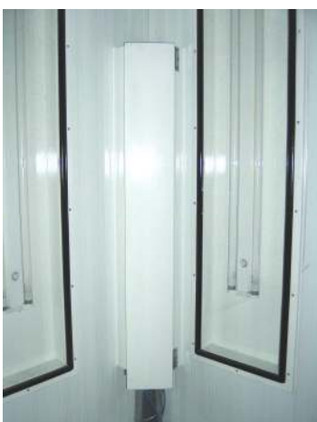
Davenka Jet Tørring med lukket låge. De automatiske låger sikrer, at der ikke kommer sprøjtetøv i anlægget
